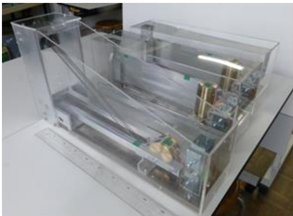
図4. 地震計全体写真(一番手前が上下動)
