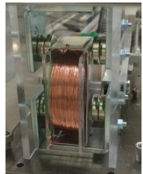
図2. 電磁センサ部の写真 (上下動)
