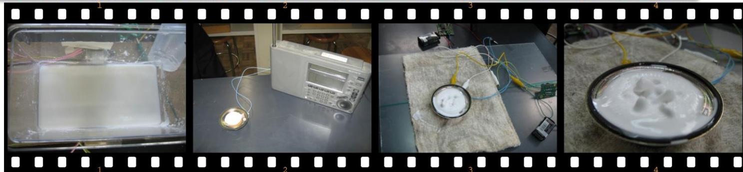
図17. コーンスターチ液に振動を与えスターチフィンガーの実験.
