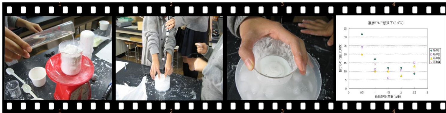
図18. コーンスターチ液の物性を鉄球を抜く力と時間で測定.
