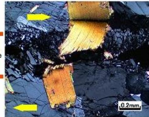
破壊実験後の岩石試料。せん断破断面に沿って変形が進んでいる。試料として長さ40mm、直径16mmの筑波花崗岩を用いた。
